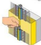
Der herausstehende Teil des Dichtbandes wird geformt und das nächste Profil wird darauf gesetzt.
