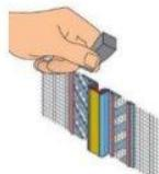
Das Dichtband wird in Form gebracht und mit halber Höhe hinter die Bewegungs-lasche geklemmt
