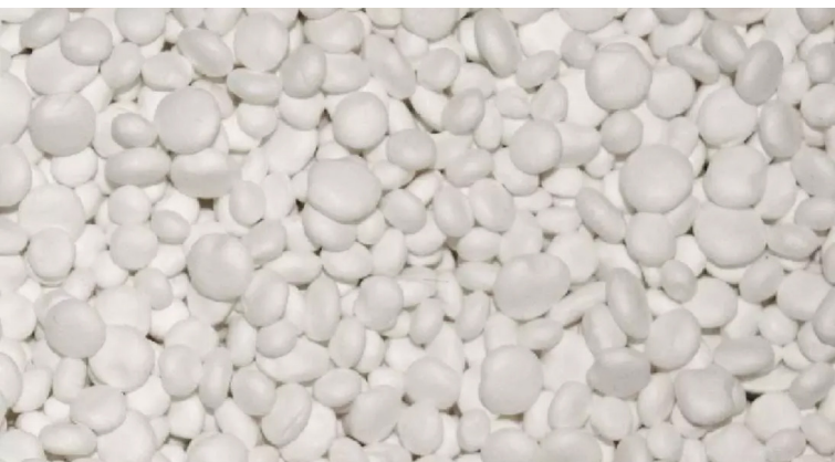
Obr. 13 - Surovina na výrobu EPS
