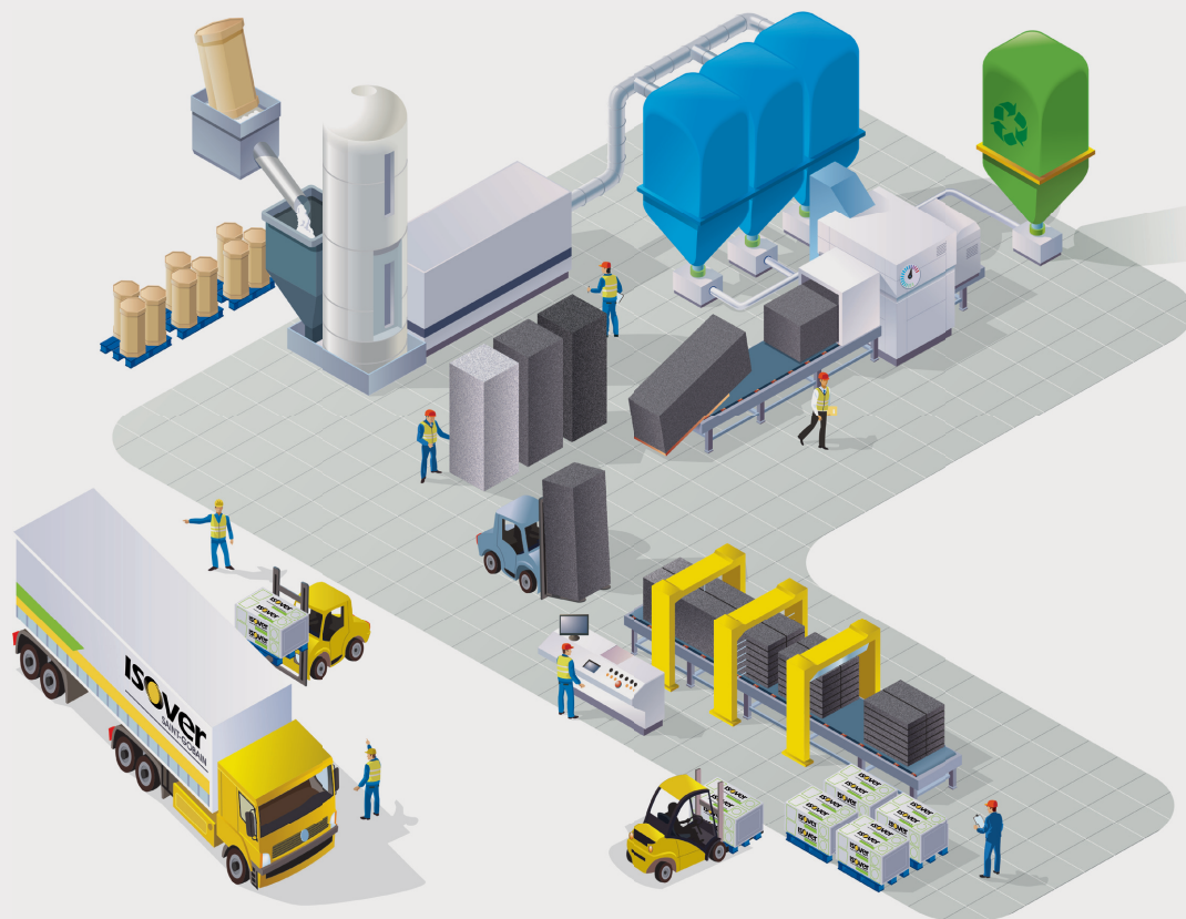
Obr. 3 - Schéma výroby pěnového polystyrenu
