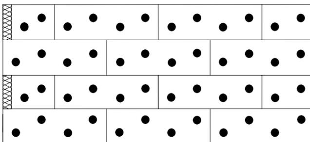
Mindestabstand Dübel zum Plattenrand beträgt 150 mm und zu den anderen Dübelschäften 200 mm.
