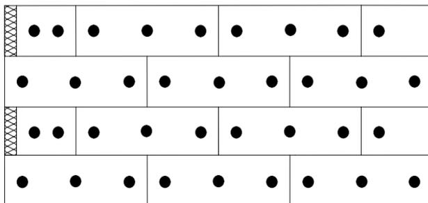
Mindestabstand Dübel zum Plattenrand beträgt 150 mm und zu den anderen Dübelschäften 200 mm.
