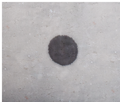
Prin observarea comportamentului suprafeței udate putem evalua absorbția suprafeței
