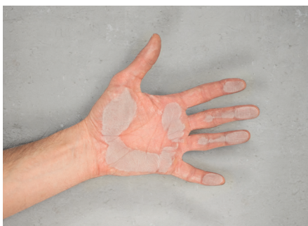
Verificarea suprafeței prin frecarea cu mâna
