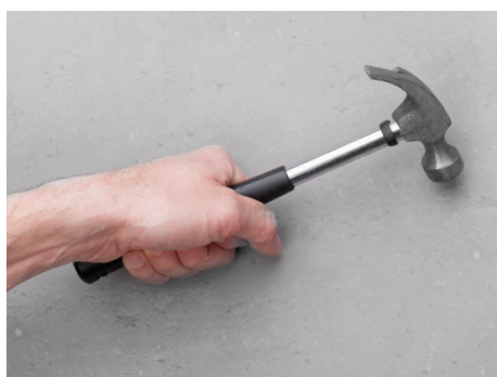
Starea suportului poate fi evaluată cu ușurință, prin baterea cu un ciocan.
